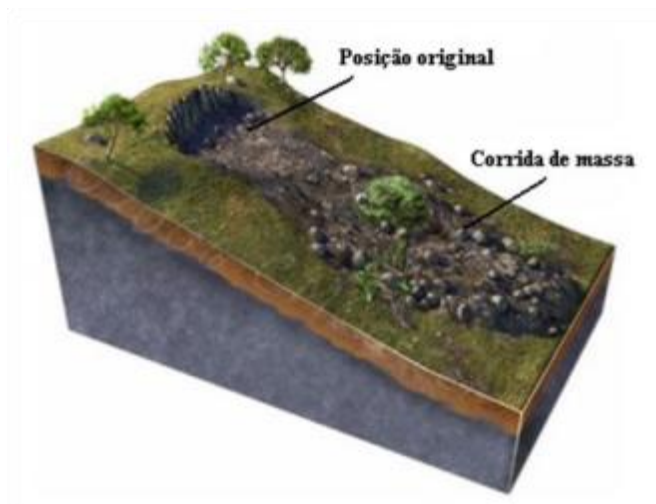
Figura 18 - Esquema escorregamento de rochas
