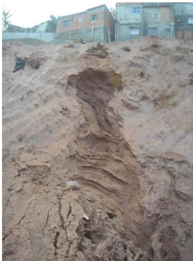
Figura 43 — Foliações no solo residual exposto pelo deslizamento, 2011
